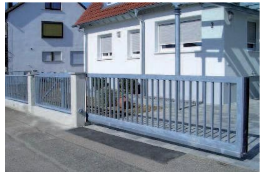
Freitragendes Hof-Schiebetor mit automatischem Antrieb
